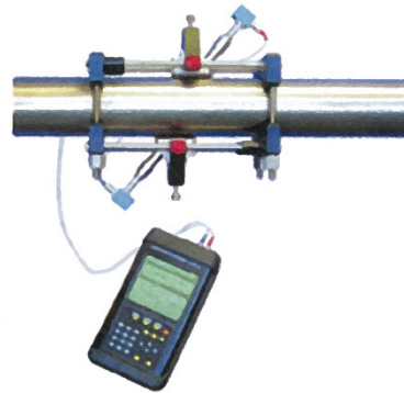
図4. 超音波流量計の原理と計測状況
